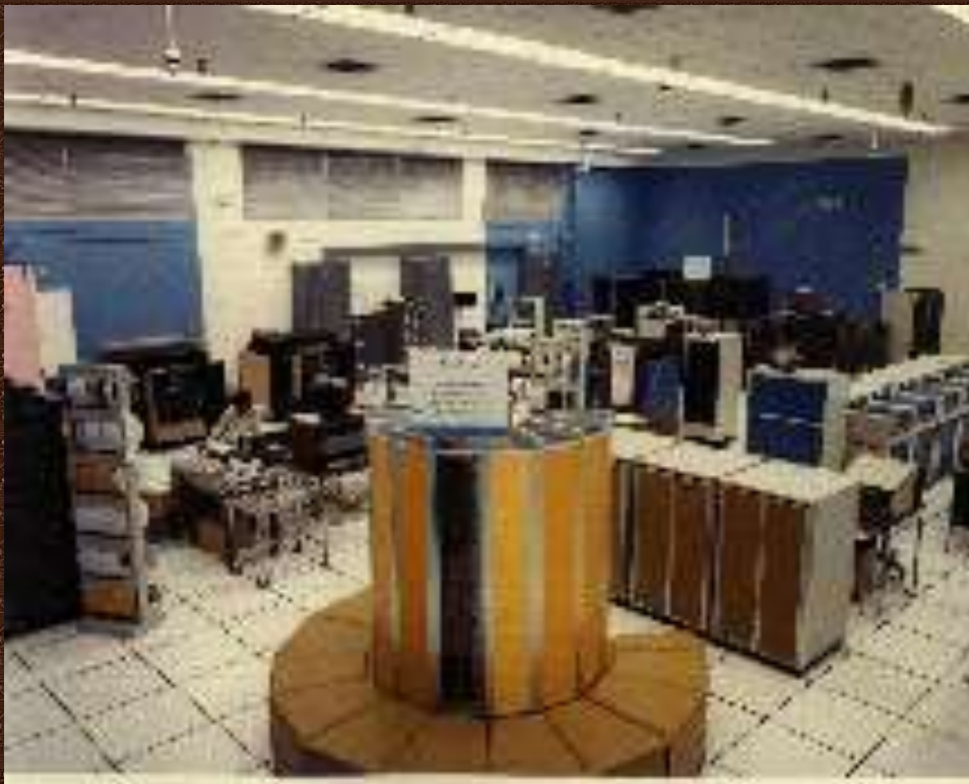
Машинный зал суперкомпьютера Cray-1. На переднем плане – центральный процессор, окруженный блоками охлаждения.
